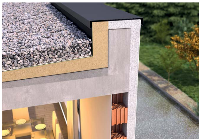
Przekrój dachu płaskiego balastowego
